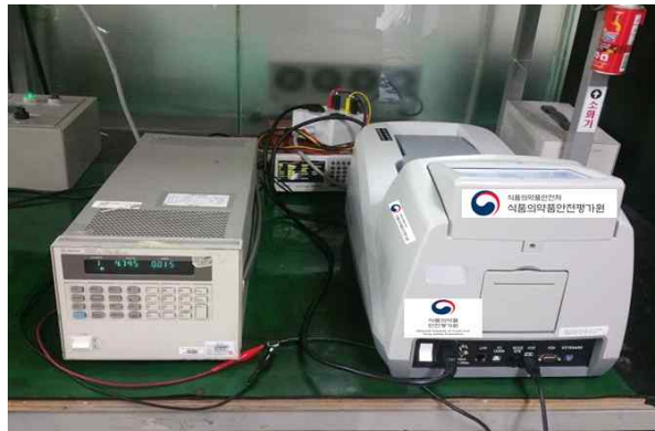
그림 16. 방출, 외장의 변형 또는 최대온도의 초과와 관련한 시험 수행 예 (사진설명: 단일고장상태에서의 에너지 소실 제한시험 수행)
