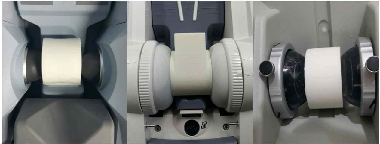
그림 12. 상용화 초음파тол도측정장치에 3D 프린팅 팬텀을 장착한 모습
