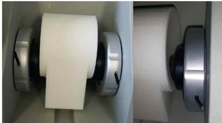
그림 13. 경사진 트랜스듀서 실리콘 커플링 패드에 3D 프린팅 팬텀을 장착한 모습
