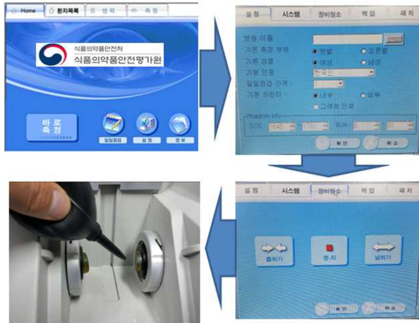
그림 3. A사 초음파골밀도측정장치 교정 전 장비 청소
