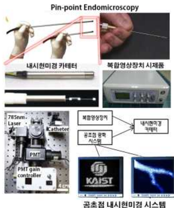
그림1. 공초점 내시현미경 시스템
