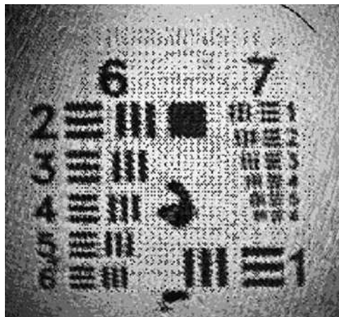
[그림 9] 최대 시야범위 시험 결과 이미지 예시
