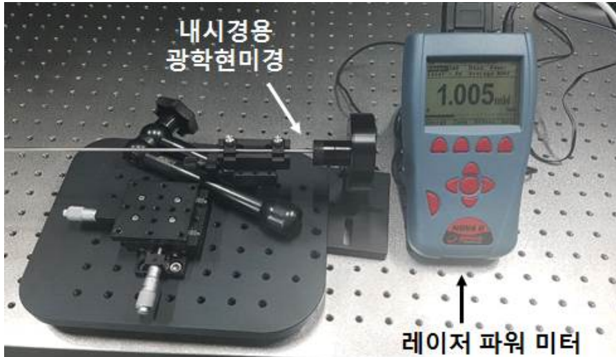
[그림 5] 레이저 출력 정확도 시험 Set-Up 예시
