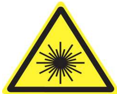
[그림 3] 경고 표시 - 위험물 표시 (IEC 60825-1 : 2007의 그림 1.)
