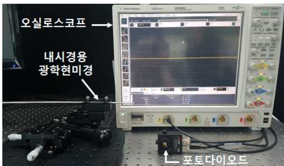
[그림 6] 레이저 출력 형태 시험 Set-Up 예시(1)
