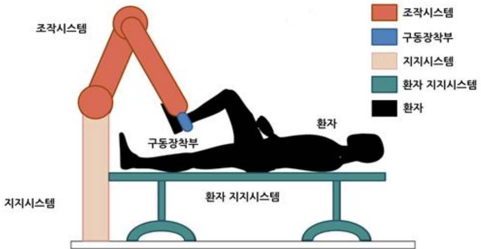
[그림 13] 하지 재활을 위한 로봇 암(arm)을 갖는 재활로봇 예제
