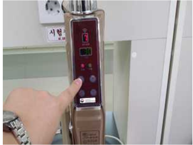
[전원 ON/OFF 제어기 정상동작 확인 ]
