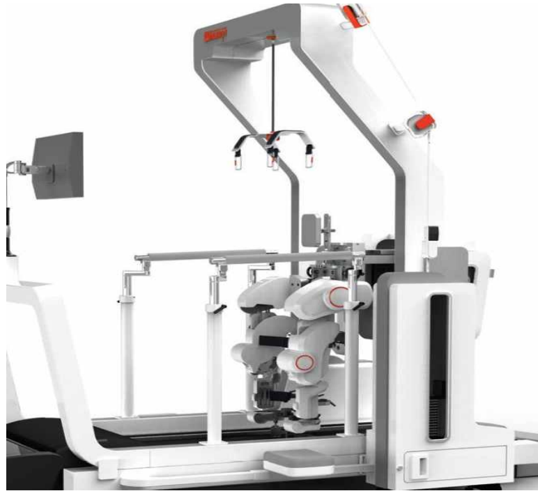
[그림2] 국내에서 개발한 재활로봇 (보행재활훈련 로봇, Walkbot, 피앤에스미캐닉스)
