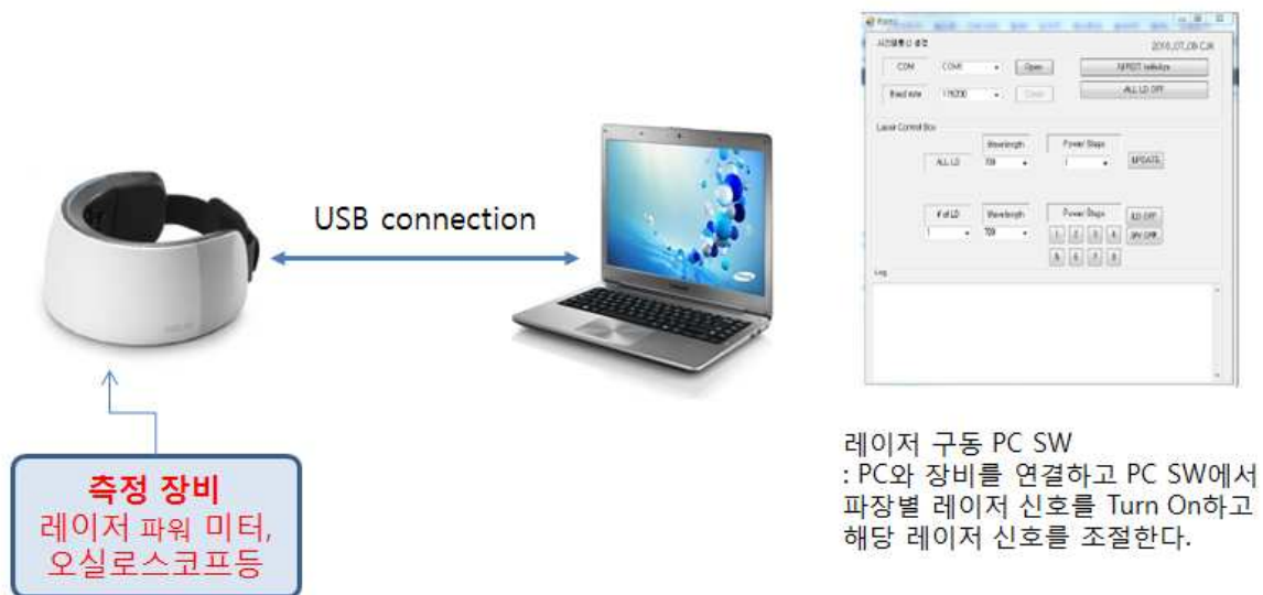
[그림 13] 레이저 시험 환경 구성
